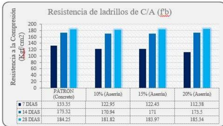
Figura 7: Resistencia a la compresión de las unidades de albañilería elaboradas con concreto y aserrín.
