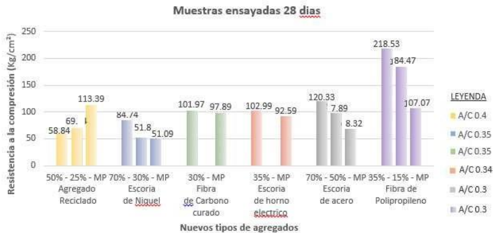
Figura 10: Comparación de f_c por tipo de agregado
